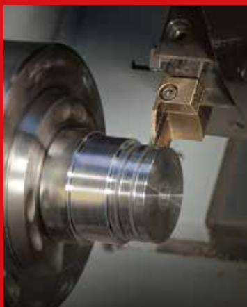
Werkzeuge und Schneideinsätze zum Ein- und Abstechen
